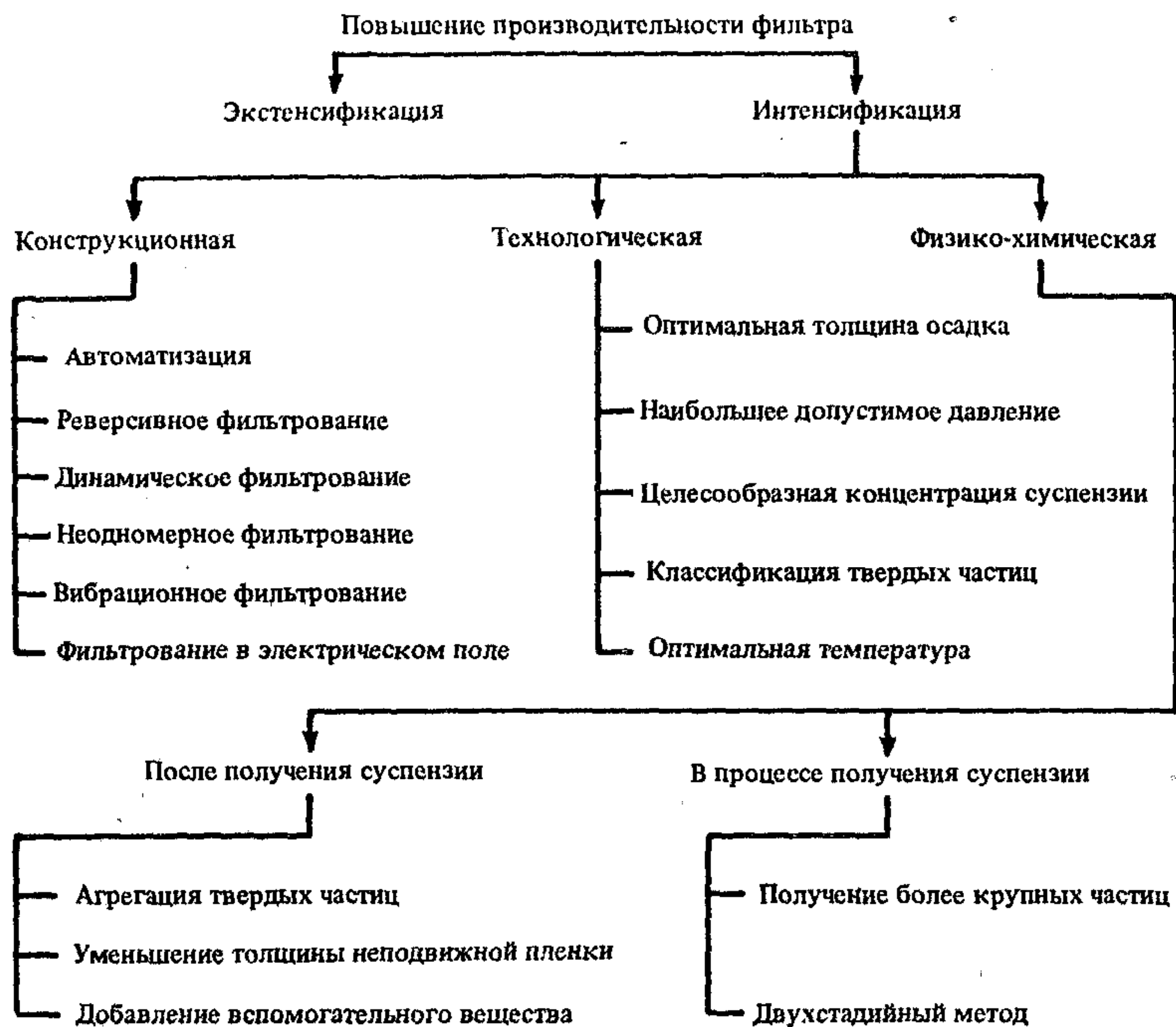
Рис. 4.2. Возможные пути повышения производительности фильтров
